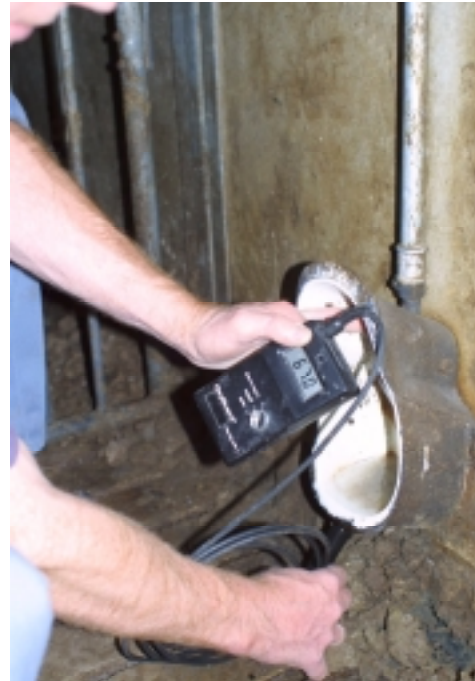
Messung des Sauerstoffgehaltes im Trinkwasser
