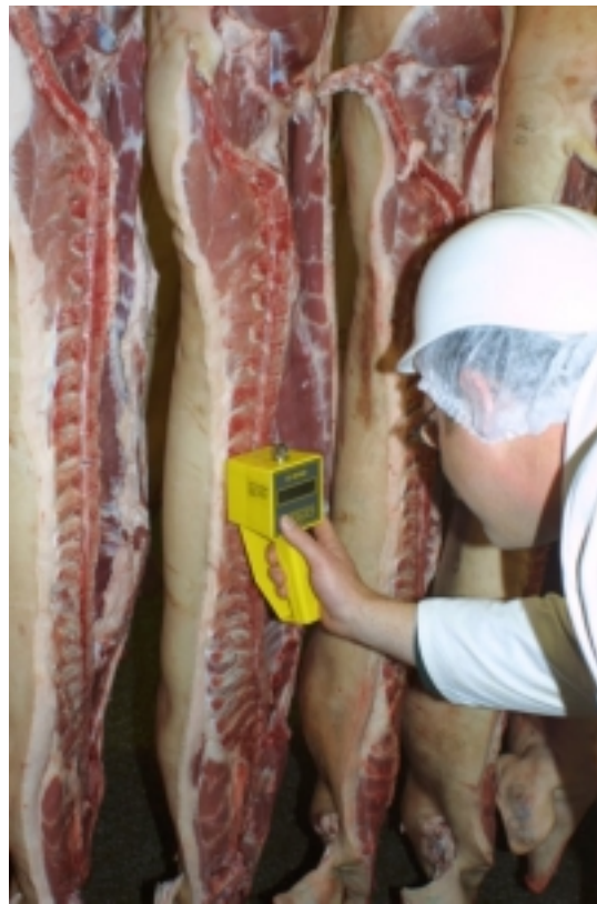
Messung der Fleischqualität am Schlachthof (LF 24 -Kotelett)
